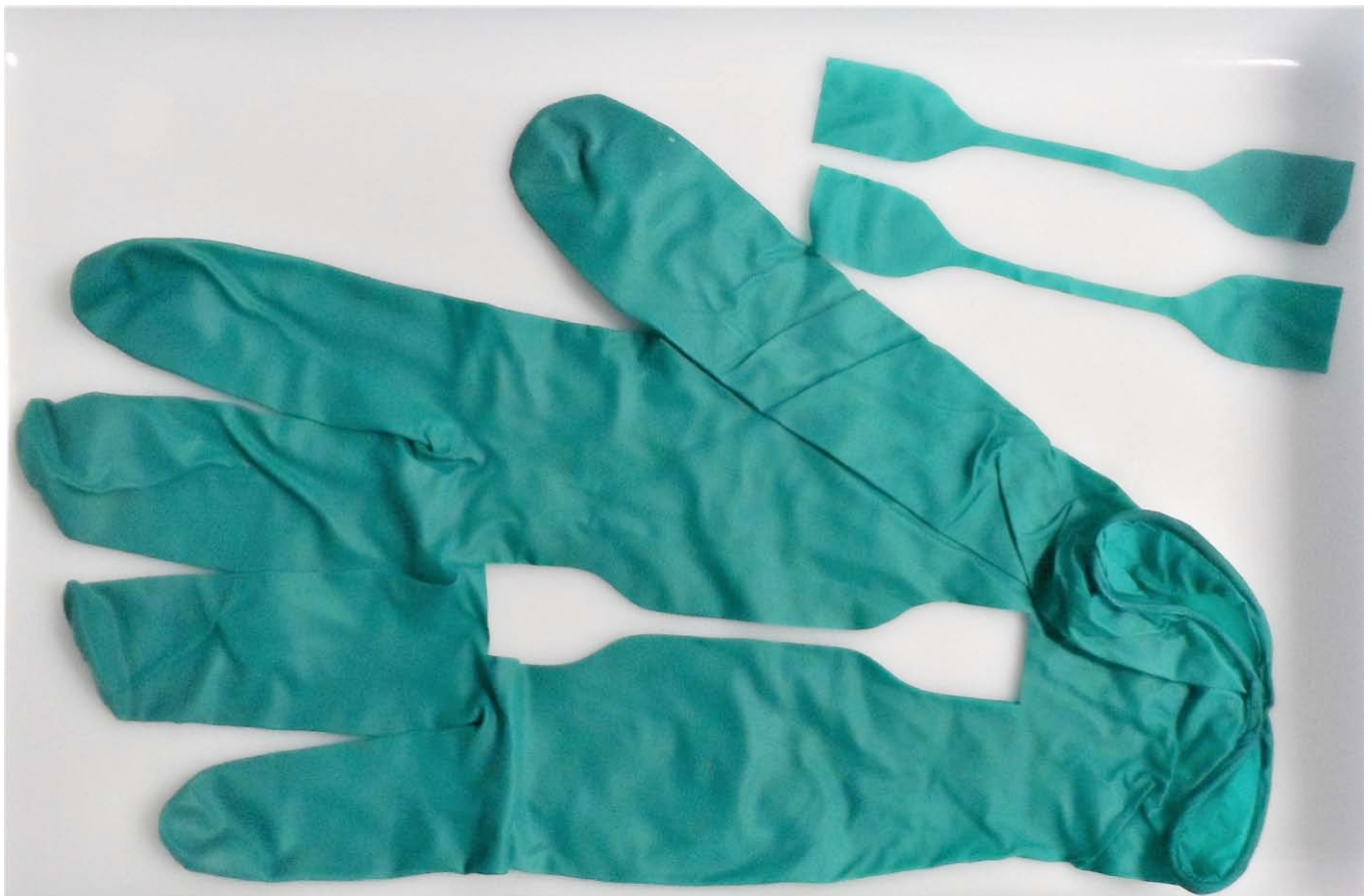
Bild 1: Solche Proben aus dem jeweiligen Handschuhmaterial werden zur Prüfung der Reißfestigkeit nach der EN 455-2 verwendet. Bild: AMPri
